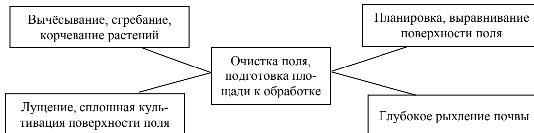
Рис. 1. Структурная схема технологических операций по очистке поля, подготовке площади к обработке.
