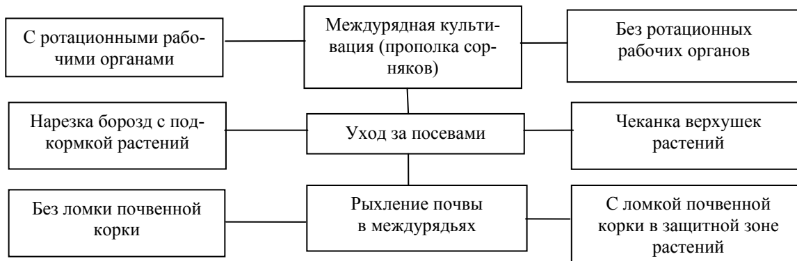
Рис. 4. Структурная схема технологических операций ухода за посевами.
