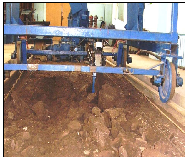
Рис. 1. Поверхность почвы после обработки исследуемым рабочим органом: а – с вибрацией, б – без вибрации.
