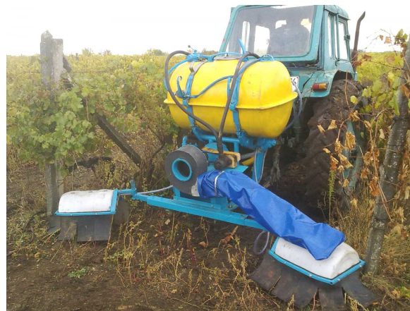
Рис. 1. Лабораторно-полевая экспериментальная установка опрыскивателя навесного гербицидного виноградикового.
